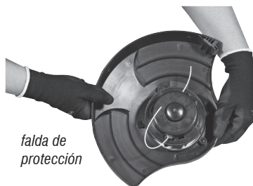
Fig. 2 – Posicionamiento de la Bordeadora para montaje.
